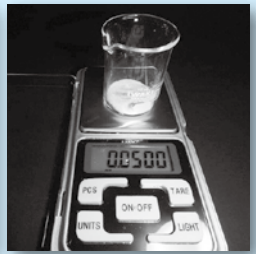
④電子はかり（0.01g-500g精密秤）で各々を計量し、同量をビーカーに移す
