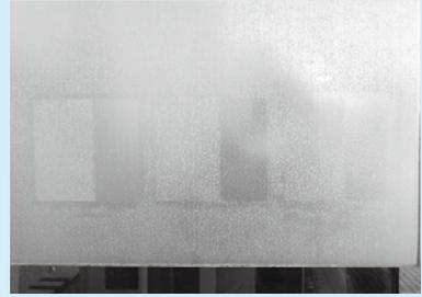
③マスキングテープを剥がした状態。表面硬化後に、触指と見え方評価を行う
