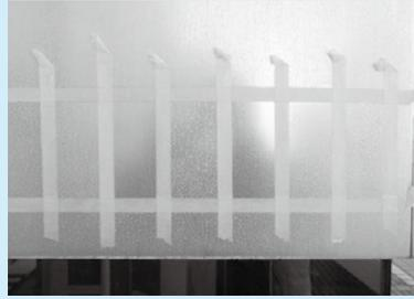
②洗浄後、各部位をさらに2分の1にマスキングテープで区切り、表面保護剤を塗布（テスト部位の表面保護処理）
